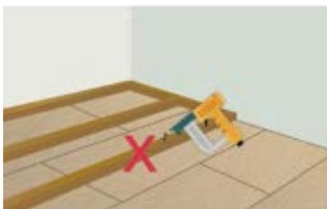
木地板鋪設完後，嚴禁木作及隔音裝潢打釘或鎖螺絲於木地板上方，若必採取此固定方式，則裝修單位須四周裁切出適當伸縮縫，以利木地板呼吸。
