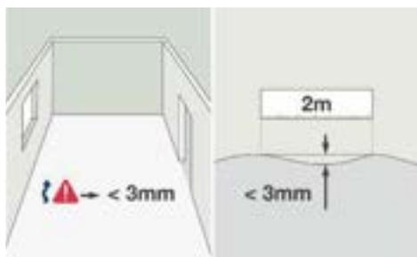
木地板施工前，水泥素地需乾燥不起砂、平整度要求：兩米直尺範圍負差不超過 3mm。
