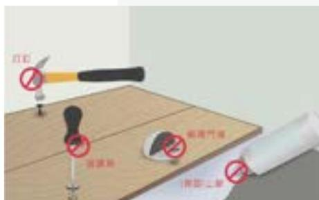
強化複合木地板採用德式汽浮式施工：嚴禁打釘、鎖螺絲、背面上膠及重壓固定，如需假性固定螺絲長度不能超過木地板厚度 (8-12mm)。
